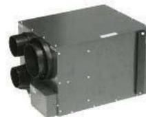
Les VRC évacuent l'air vicié et procurent de l'air neuf dans l'habitation, mais sans que l'air contaminé n'entre en contact avec l'air neuf. Ils offrent souvent plusieurs modes de contrôle et ont la particularité de récupérer une partie de la chaleur de l'air vicié et de la transmettre à l'air neuf pour diminuer les pertes de chaleur.
