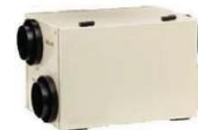
Les noyaux récupérateurs de chaleur, quant à eux, fonctionnent sensiblement comme les VRC, mais ils ne sont pas munis d'un moteur, car ils utilisent la soufflerie d'une fournaise pour échanger l'air. Ils fonctionnent généralement avec des contrôles plus sommaires.
